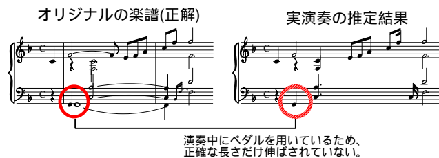
図 11 継続時間が短いためにおこる音価推定誤り
