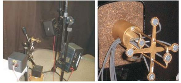
図 6. 実験系外観 (左) とマイクロフォンアレイ (右)
